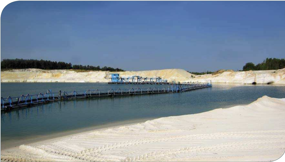
Abb. 2: Gewinnung von hochwertigem Quarzsand durch Saugbaggerschiff im Quarzsandwerk Uhry der Schlingmeier Quarzsand GmbH & Co. KG, Foto: BGR.
